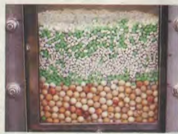
比重を利用し選別する装置「ジク」。選別前(上)と選別後(下)
